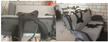
vi. Der Gurt ist nach hinten über den Sitz gelegt, so dass die Passagiere sich nicht mit dem Rücken darauf setzen. Der Gurt ist dann leicht überzustreifen wenn der Kopf der Passagiere leicht nach hinten geneigt ist. Über den Kopf gestreift ist dann vorne ein leichtgängiger Druckverschluss links und rechts mit der Möglichkeit der Längenveränderung. Reicht die Anpassung am Druckverschluss vorne nicht aus, kann an der Gurtbefestigung der Gurt insgesamt verlängert oder verkürzt werden.
