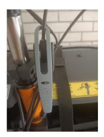
Nach oben anheben, dann löst sich die Bremse. Nach unten drücken (wie im Bild) wird die Feststellbremse wirksam. Damit steht nicht nur die Rikscha, auch die Elektrik ist ausgeschaltet, Tacho ist noch an.
