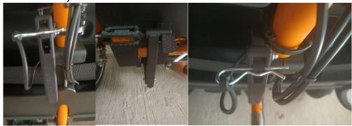
Nach dem Arretieren der Einstieghilfe den Fußhebel locker nach oben heben bis über die Sperre, diese hält den Fußhebel oben. Die Sperre selbst nicht bewegen! Dann unbedingt den Splint zur Sicherung des Einstieghilfe-Hebels einziehen! Gerade Seite des Splints zeigt zum Hebel.
